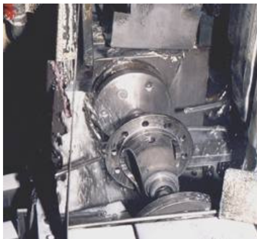
Fräsvorgang an Differentialgehäusen mit Kugelgraphitanteilen
