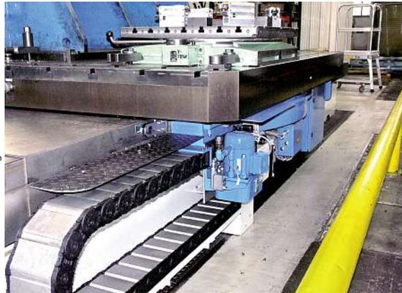
**Bild 4:** Mit der Umrüstung wurden die Achsantriebe erneuert. Die Antriebe für Tisch-, Ständer-, Spindelkasten und Spindelvorschub wurden auf AC-Servo-Einzelantrieb umgestellt.
