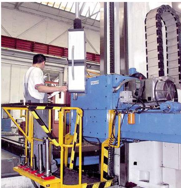
**Bild 1:** Das Alter alleine ist noch kein Grund, eine Werkzeugmaschine abzuschreiben. Durch ein Retrofit von Steuerung und Antrieben können Jahrzehnte alte Maschinen wieder auf einen technischen Stand gebracht werden, der aktuellen Anforderungen genügt.
