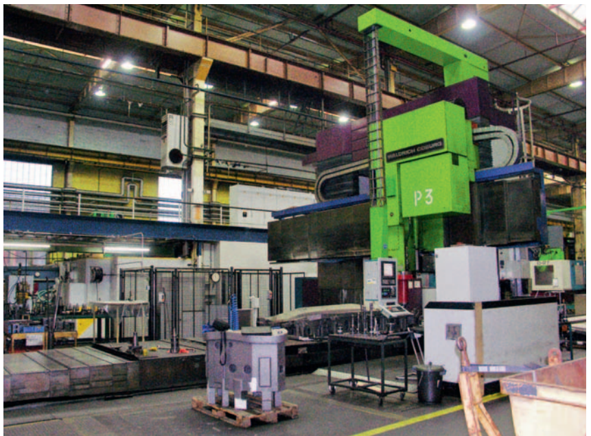
1 In neuem Glanz: die Portalfräsmaschine Waldrich 17-S P225 nach der Modernisierung von Hellwig mit der jetzt viel zu großen ›Schaltschrank-Bühne‹, die vorher für 16 Meter Schaltschrank Platz bieten musste
