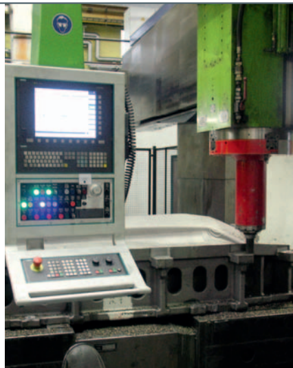
3 Neu im Einsatz: Die Steuerung Sinumerik 840 D für zwölf Achsen passt in die Steuerungswelt der anderen am Standort eingesetzten Werkzeugmaschinen
