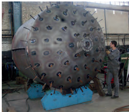
Ein Abhitzekeessel mit gedrehten Elementen aus der Borsig-Fertigung in Berlin.
