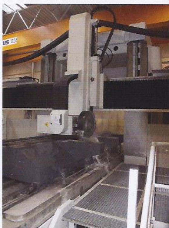
Bild 5: Die zur Fräsmaschine umgebaute Aschersleben Hobelmaschine von vorne
