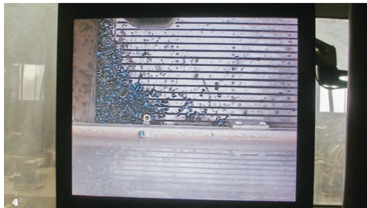
3 Die Herkules mit eingespannter 20-Tonnen-Walze, links im Bild die mitfahrende Bedienkabine. 4 Der Videobildschirm in der Kabine zur Überwachung der Nachbarmaschine.
